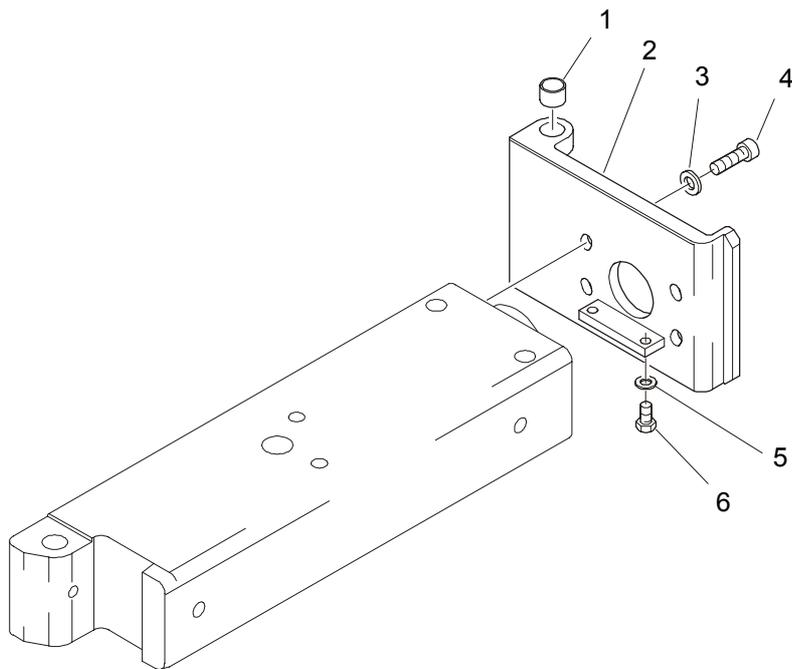
**Trägerplatte für Abdrehgetriebe 828****937.510.000**
