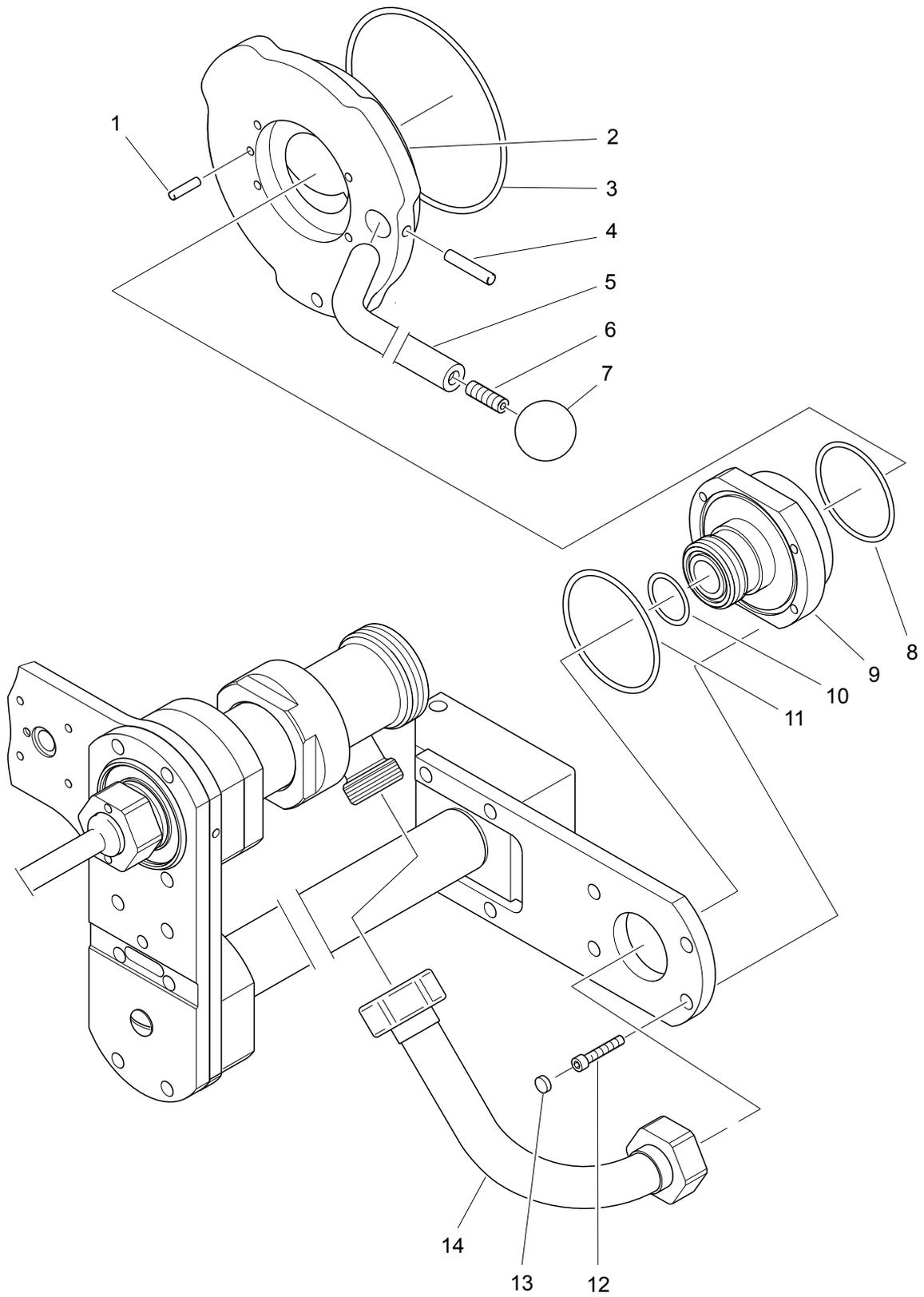
**Verbindungsrohr A-Maschine kpl.
