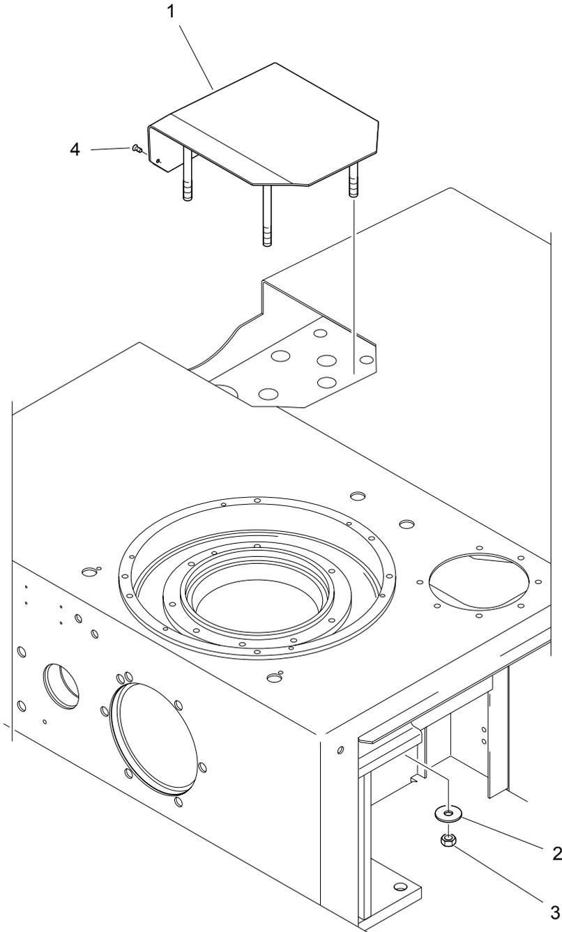
**Verschlusssteile für Maschinengehäuse ohne Hebe- und Kippvorrichtung****163400005**
