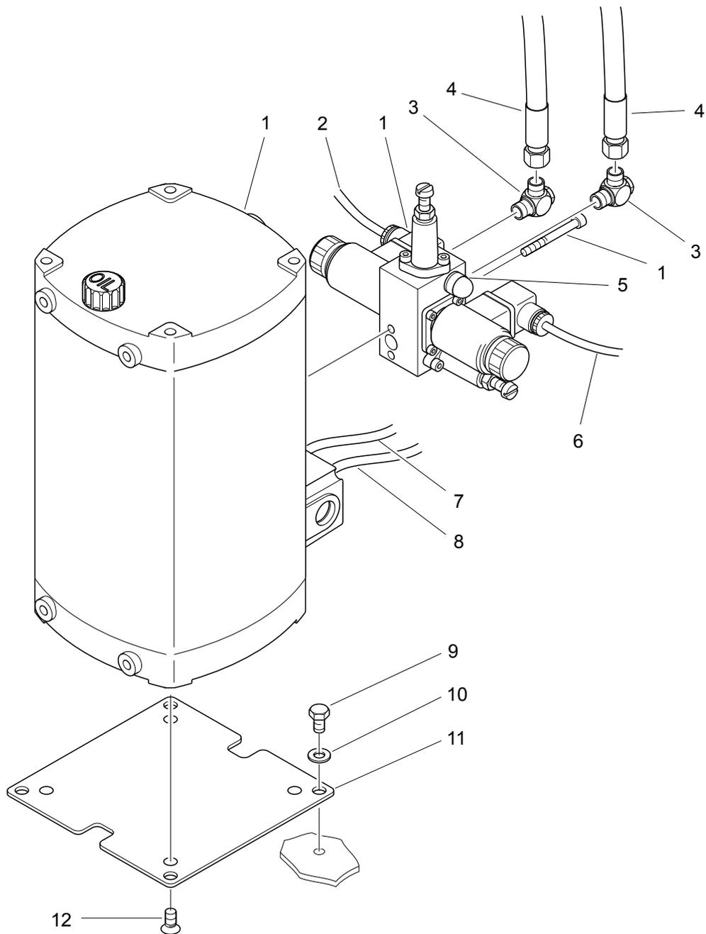
**Hydraulische Steuerung für Hebe- und Kippvorrichtung (Option)****163450001**
