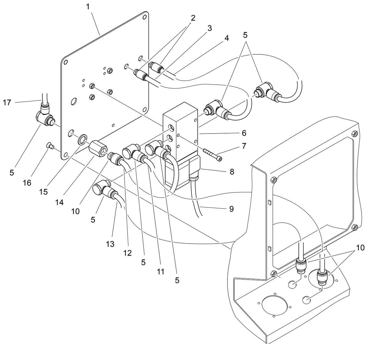
**Pneumatik für Trennventil kpl.****163170002**
